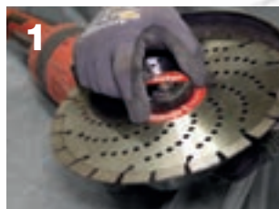
1 Nokey® einfach per Hand festziehen Tighten the nokey® by hand
